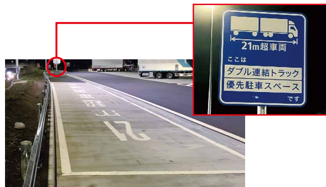
中央道 小黒川PA（下り）ダブル連結トラック駐車マス
