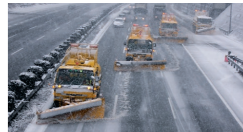
梯団走行による除雪作業
