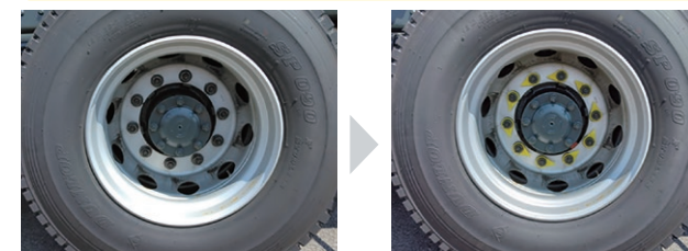
グループ外で発生した脱輪による死亡事故や、グループ内で発生した路面清掃車の脱輪事象を参考に、対策としてナットインジケーターの装着を展開した事例
