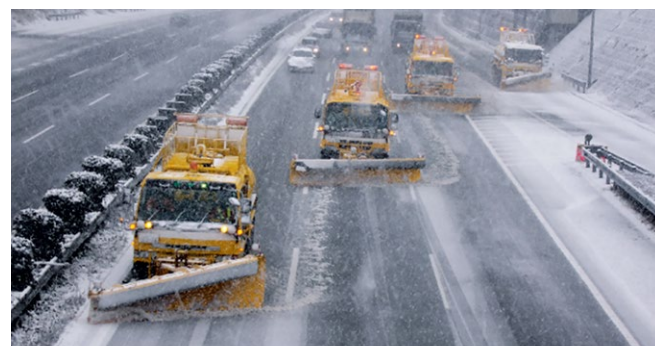
梯団走行による除雪作業
