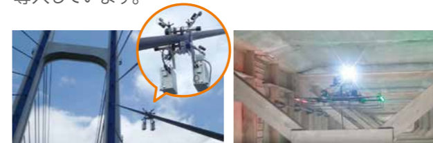
斜張橋における斜材の点検ロボット 細部点検用ドローン(SCIMUS)
