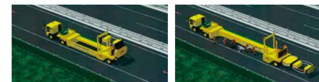
大型移動式防護車両(左:走行時、右:作業時)
