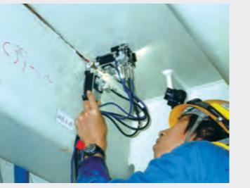
フェイズドアレイ(橋梁に発生する亀裂を検知する手法)
