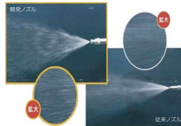
共同開発した飛散を低減させる環境対応型ノズル
