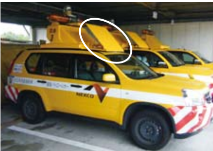
整流板（○囲み）を取り付けた試作車両
