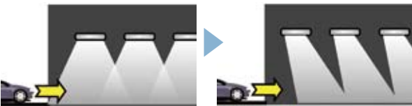
対称照明／対称照明では路面は明るく、車はやや暗く見えます。プロビーム照明／プロビーム照明では路面は暗く、車は明るく見えます。
