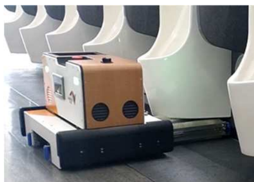
【狭小部清掃ロボット運用状況】
