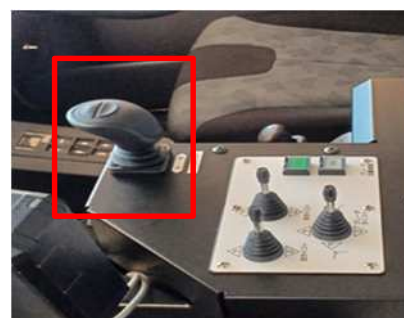
【除雪車の操作卓(ジョイスティック化)】
