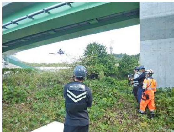
【無人航空機(UAV)を用いた橋梁の点検実施状況】
