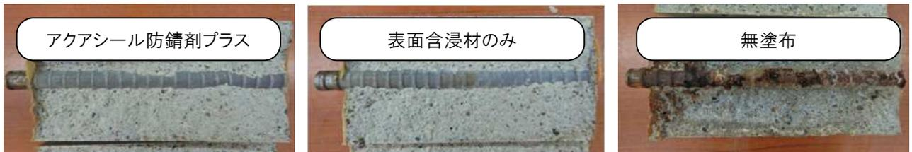
【促進試験後の鉄筋腐食状況】
