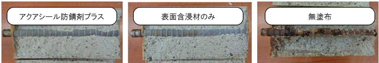
【促進試験後の鉄筋腐食状況】
