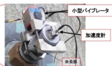
【新技術による測定(アンカー頭部)】
