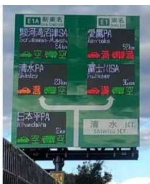
【経路分岐部の車種別満空表示板】
