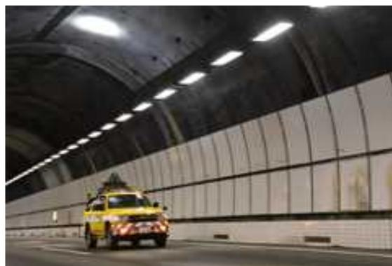
【高速画像処理を用いたトンネル内点検技術】
