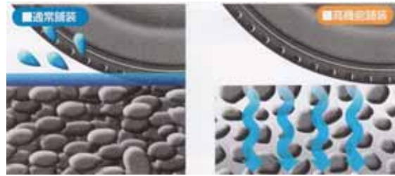
図．高機能舗装の仕組み
