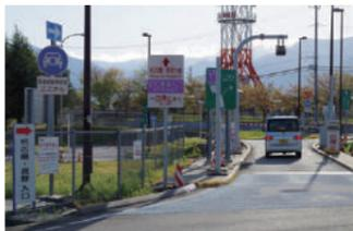
双葉サービスエリアに併設されている双葉スマートIC。上からぶら下がっているのがETCのアンテナ（路側無線装置）だ。
