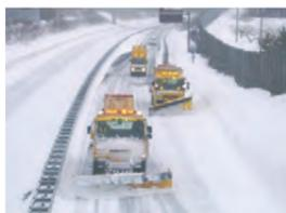
「スノーブラウ」という巨大スコップ。除雪作業をしない移動のときは折り畳んで走行します。路面にキズを付けないように、先端にウレタン製の爪が付けられています。松本は雪の多い地域となるため、スノーブラウの上部が斜めになっています。太くなっている側から雪を横に押し出しながら、道路上の除雪をしています。
