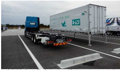
(中継する荷室を取り換えるトラック)
