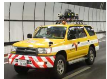
(高速で精度良くひび割れを計測)
