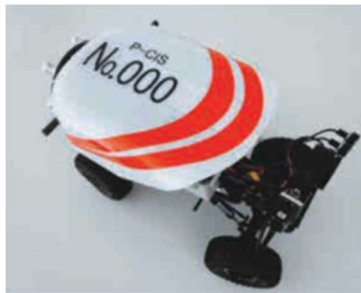
【ロボットを用いた管路内の点検】
