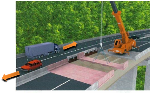
床版取替え工事のイメージ
