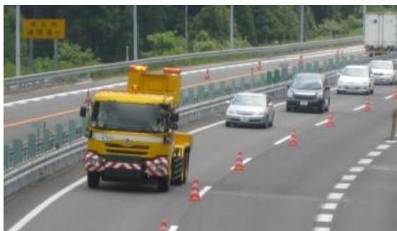
ペースカーによる速度抑制の例
