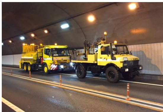
(トンネル壁面清掃)
