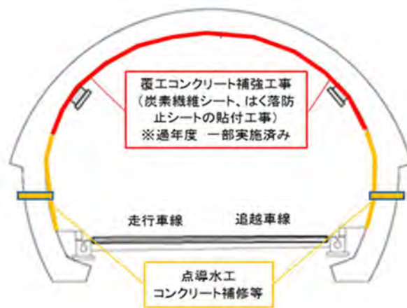
辰野トンネル補強工事概要
