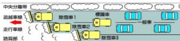
雪が降ると1編成2～3台の除雪車で低速走行による除雪作業を行い、安全で走りやすい路面を確保しています。
