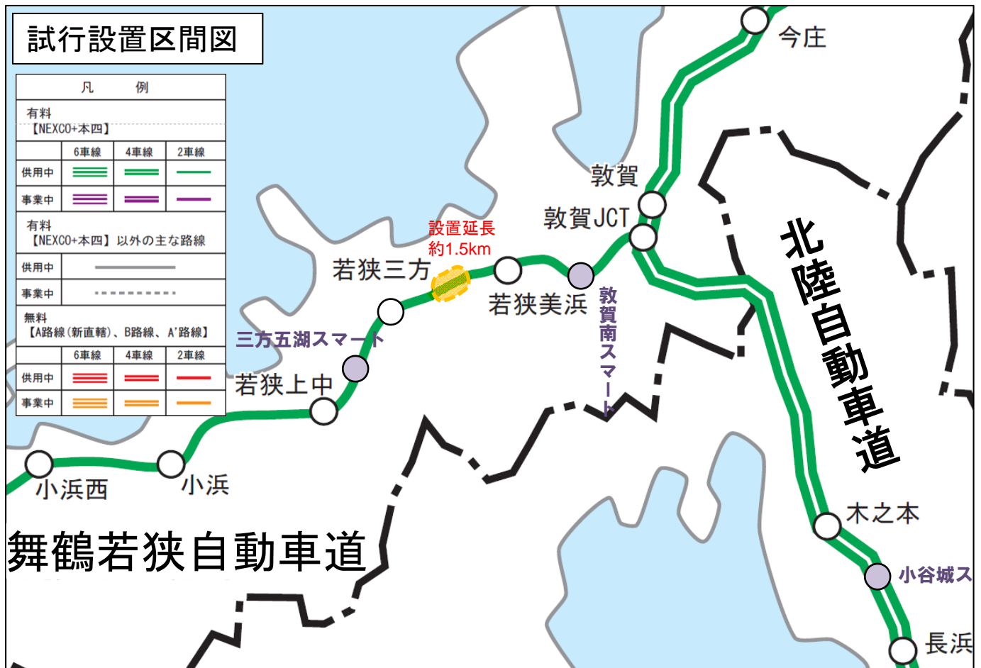
凡例 ワイヤロープ試行設置区間
