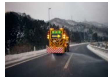
■凍結防止剤散布作業
