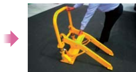
④アームをロック 爪に完全に固定されているか確認する。
