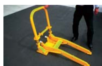
③マストを起こす マストを起こしたら固定用穴にボルトなどを差込みロック。
