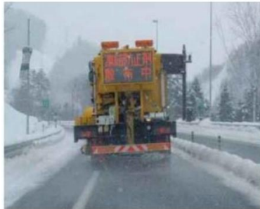
【写真1】凍結防止剤散布状況
