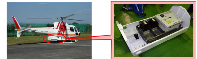
写真⑬ << 転石、土石流等への航空レーザー計測技術の活用 >>
