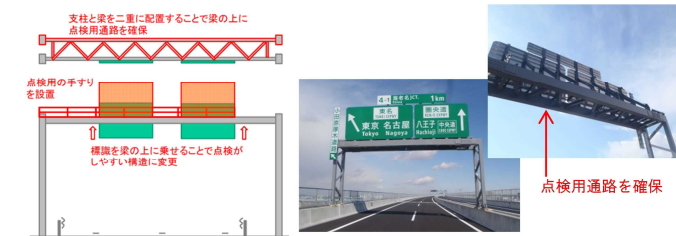
写真① <維持管理しやすい道路の設計・施工の取組提案例> 大型標識の点検用通路の確保
