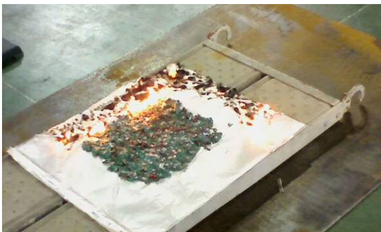
塗膜くずの延焼性確認状況
