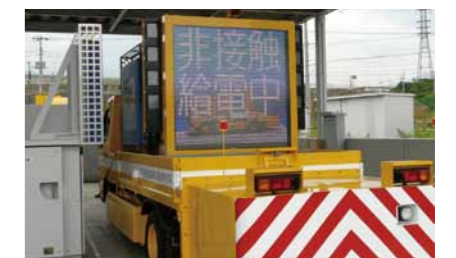
ワイヤレス給電装置(写真左)と給電中の標識車
