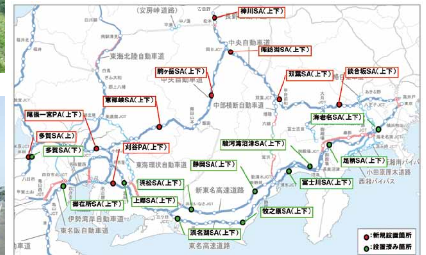
EV用急速充電器設置箇所
