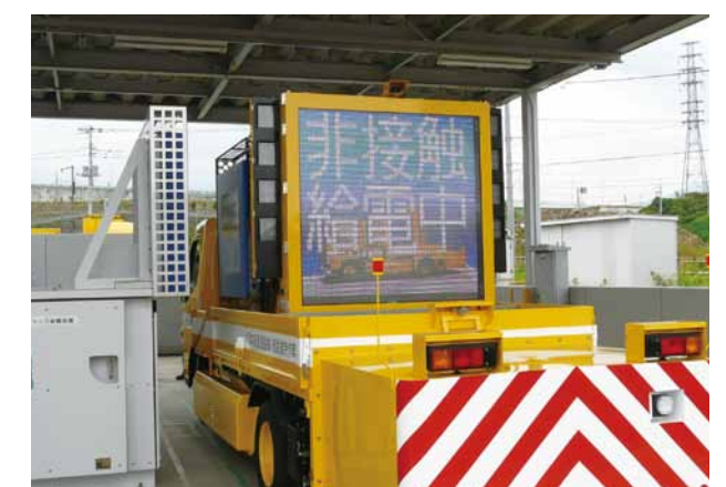
ワイヤレス給電装置(写真左)と給電中の標識車
