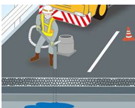
深層改良による舗装補修
