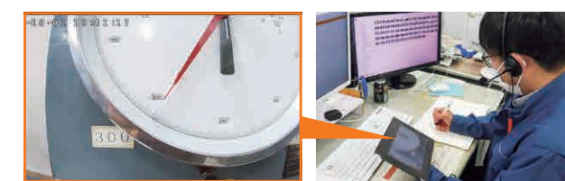
WEB会議システムを活用した遠隔臨場による立会検査
